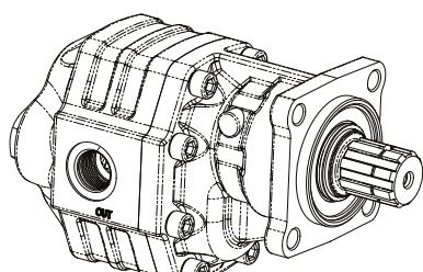
Abyste zabránili opotřebování drážek, namažte hřídele, spojky a pouzdra během instalace.
